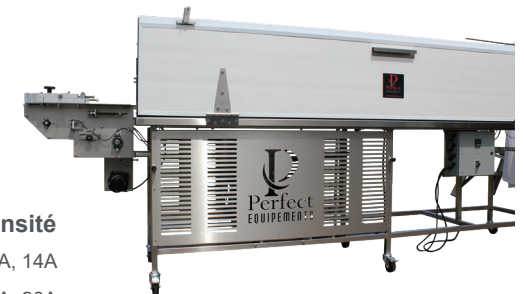
Tunnel de refroidissement
